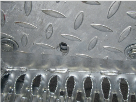
Schutzblech wird mit 2 Schrauben 10 x 25 und 4 Beilagscheiben mit der Trittplatte verschraubt. Bohrung Mitte ist für Auspuffschelle.
