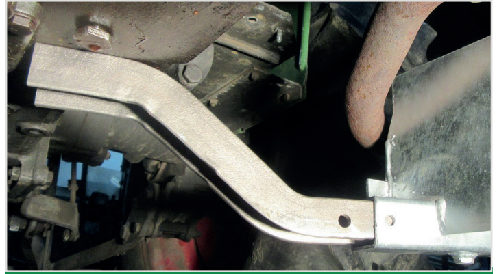
Befestigung der Trittplatte am Tritthalter, Sicherung mit Schraube.
