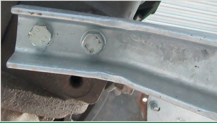
Tritthalter wird mit 2 Schrauben 12 x 25 und Sprengring am Getriebeblock befestigt.
