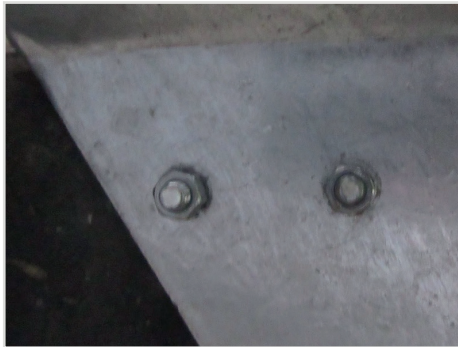
(Ansicht von unten) Am Trittbrett des Schleppers 2 Bohrungen anbringen. Schutzblech wird mit 2 Schrauben 8 x 25 mit dem Trittbrett verschraubt.
