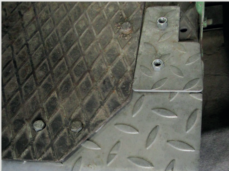
Falls erforderlich: Kleine Lücke am Trittbrett mit kleinem Schutzblech verschließen.
